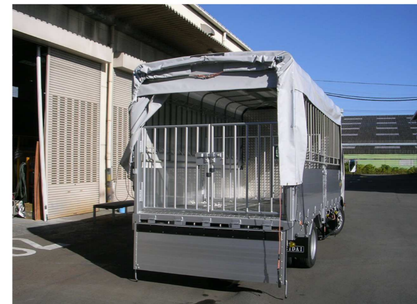
④リヤの逃走防止用仕切(観音式180度回転)
