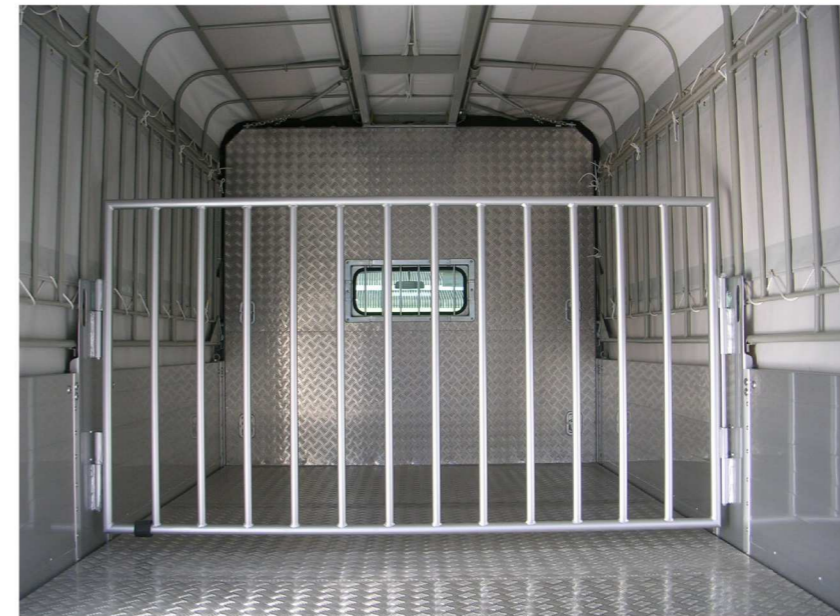
④リヤの逃走防止用仕切(観音式180度回転)
