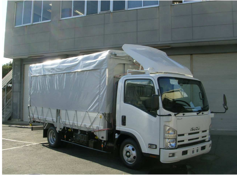
②サイドシートを脱着式にしました 骨格ピッチ150mm、逃走防止、中間ロック付
