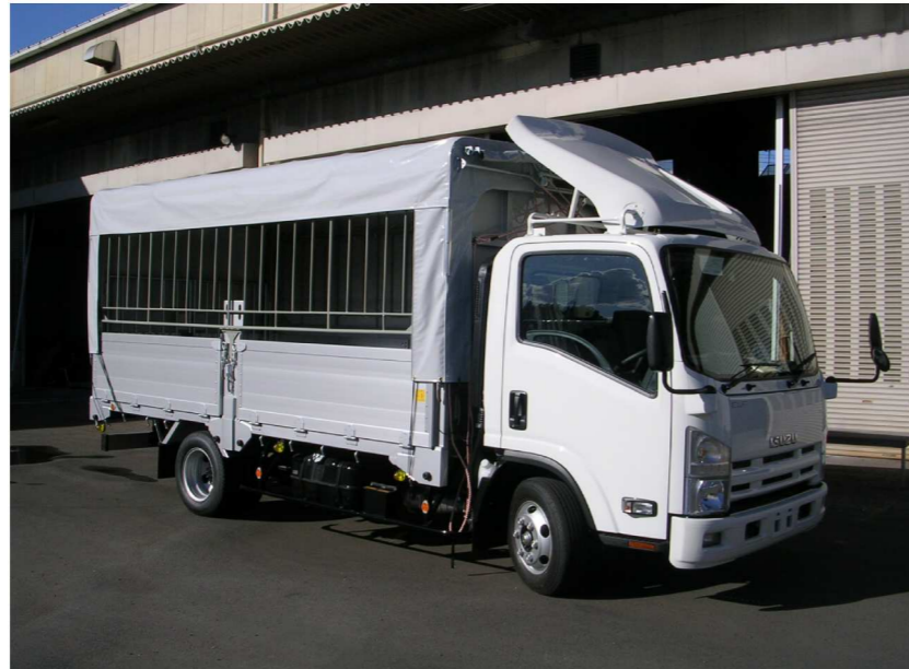
②サイドシートを脱着式にしました 骨格ピッチ150mm、逃走防止、中間ロック付
